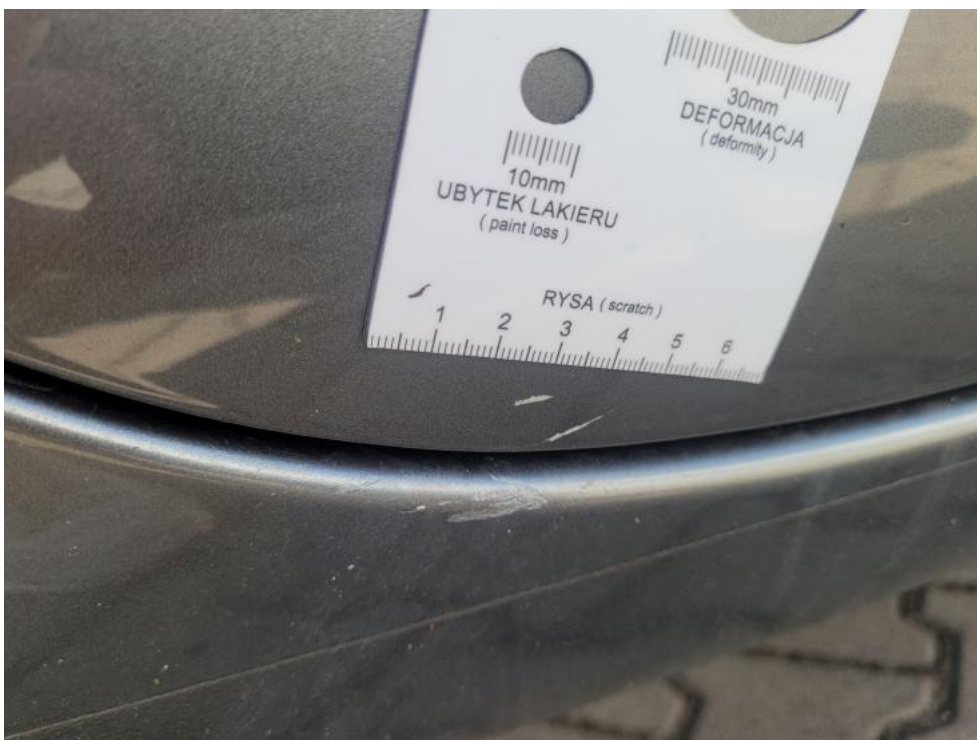
Fot. 28. Drzwi T P - zarysowanie 1
