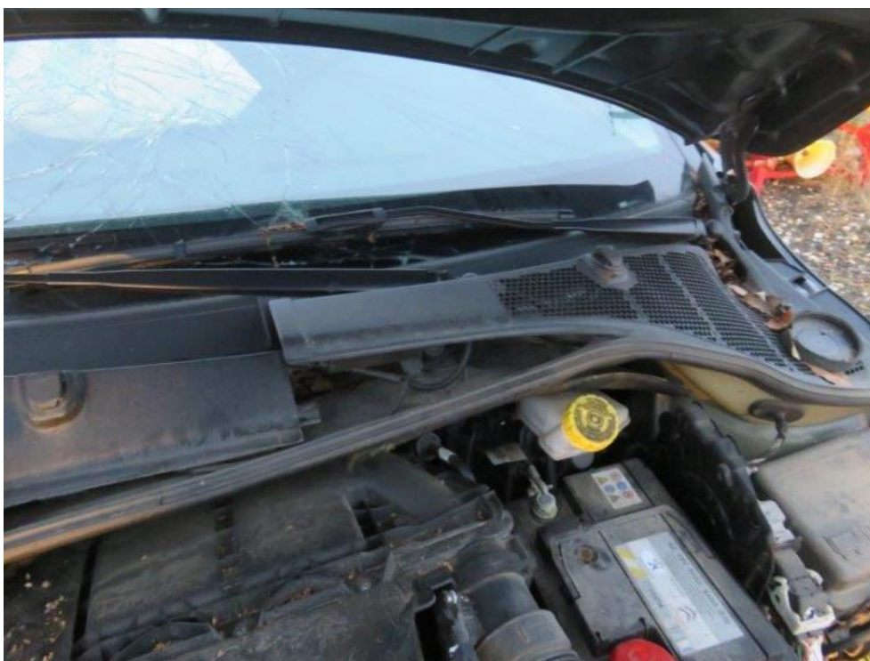
Fot. 35. ściana grodziowa komory silnika
