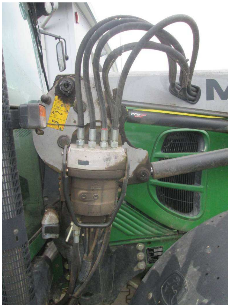
Zdjęcie 5 – sterowanie, napęd hydrauliczny ładowacza
