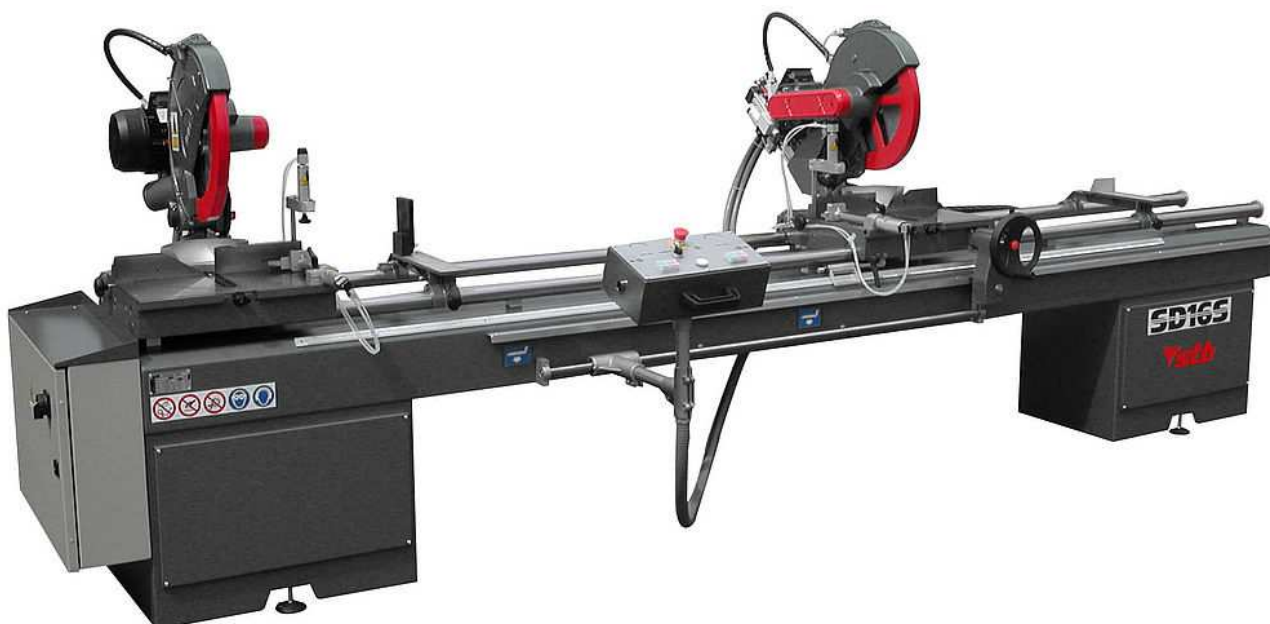
Piła typ SD16S dwugłowicowa do cięcia długich profili z PCV i AL.
