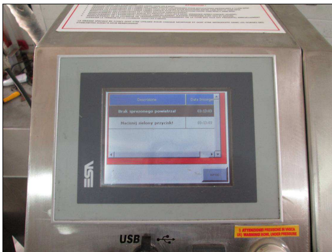
Zdjęcie 4 – Panel sterownia - dotykowy Kutra próżniowego z indukcją magnetyczną do obróbki termicznej i mechanicznej model RS 60, nr seryjny: 101
