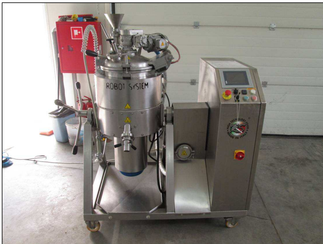
Zdjęcie 1 – Widok z przodu Kutra próżniowego z indukcją magnetyczną do obróbki termicznej i mechanicznej model RS 60, nr seryjny: 101
