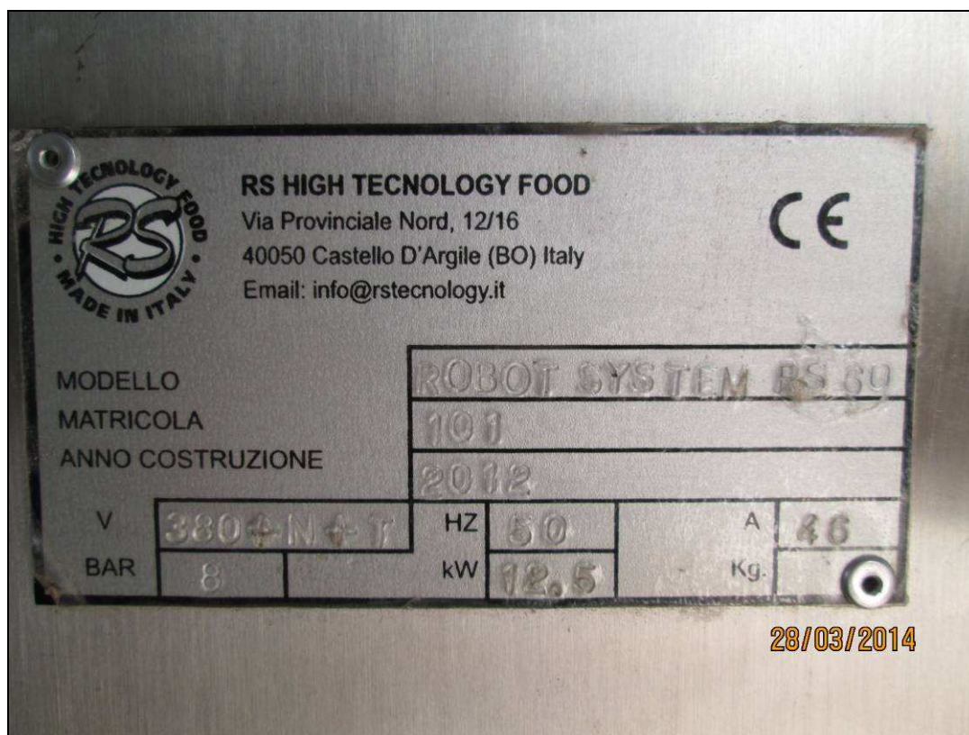
Zdjęcie 2 – Tabliczka znamionowa Kutra próżniowego z indukcją magnetyczną do obróbki termicznej i mechanicznej model RS 60, nr seryjny: 101
