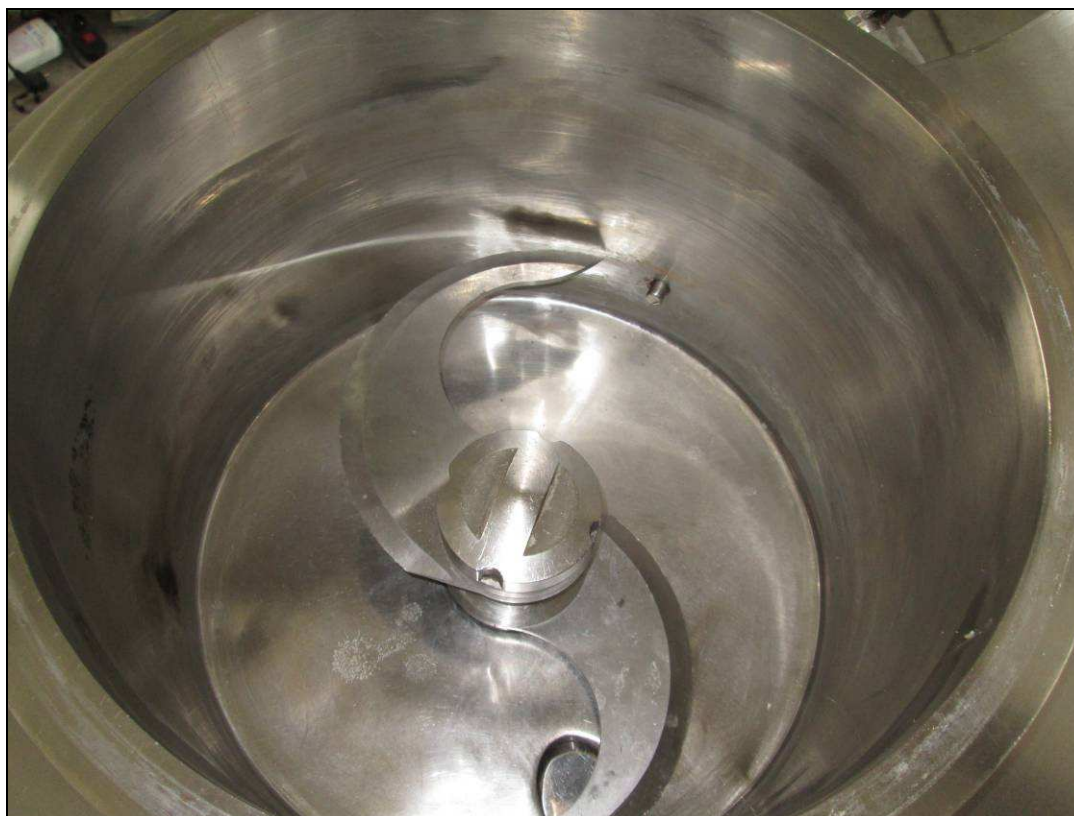
Zdjęcie 3 – Wnętrze miski roboczej Kutra próżniowego z indukcją magnetyczną do obróbki termicznej i mechanicznej model RS 60, nr seryjny: 101
