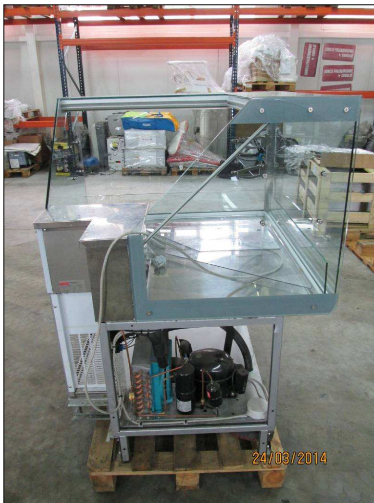
Zdjęcie 4 Widok z boku – urządzenia robocze Chłodniczej witryny ekspozycyjnej SNACK 90°, nr seryjny 1108090706
