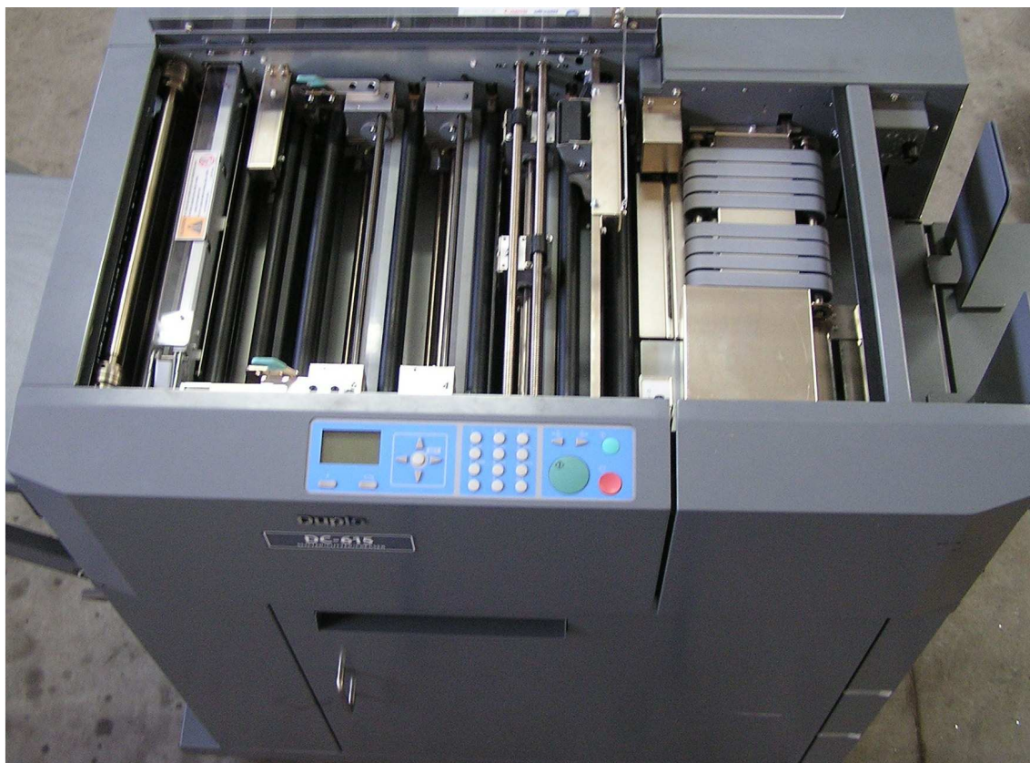
Fot. 5 Maszyna introligatorska DUPLO DocuCutter DC -615 – widok z góry na mechanizmy maszyny. Widoczny sterownik maszyny.
