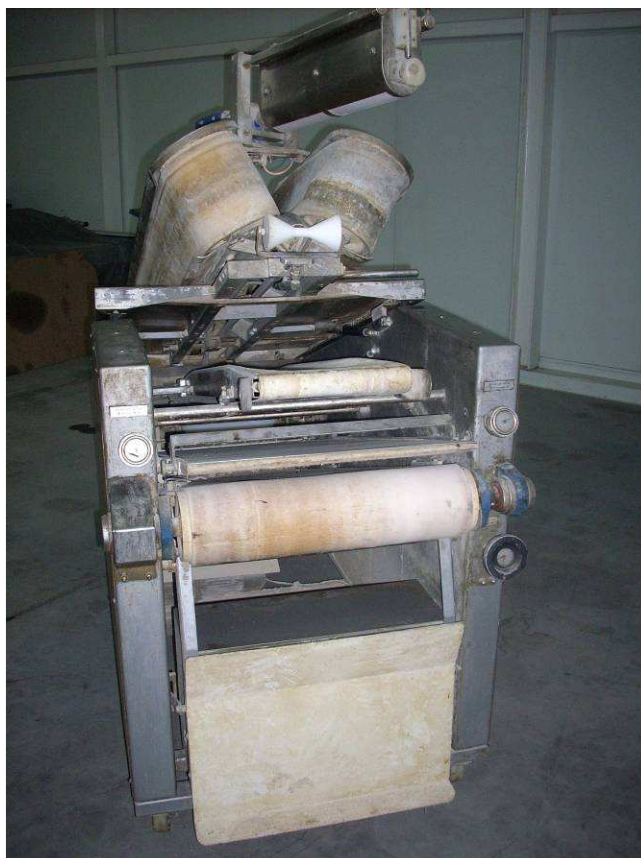
Zdjęcie 2 – Dzielarko – wydłużarka do chleba Hert Kemper Superba 07T30 SU KOMPAKT nr seryjny: 687034, rok prod.:2008 – widok od czola maszyny.
