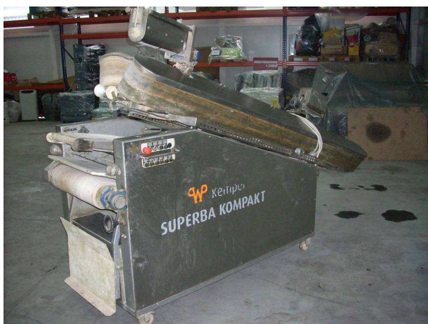
Zdjęcie 3 – Dzielarko – wydłużarka do chleba Hert Kemper Superba 07T30 SU KOMPAKT nr seryjny: 687034, rok prod.:2008 – widok na pulpit sterowniczy.
