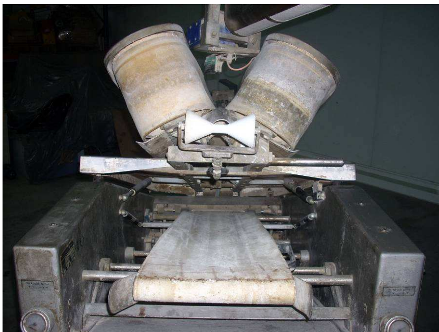
Zdjęcie 3 – Dzielarko – wydłużarka do chleba Kemper Superba 07T30 SU KOMPAKT nr seryjny: 687034, rok prod.:2008 – widok na pasy transmisyjne
