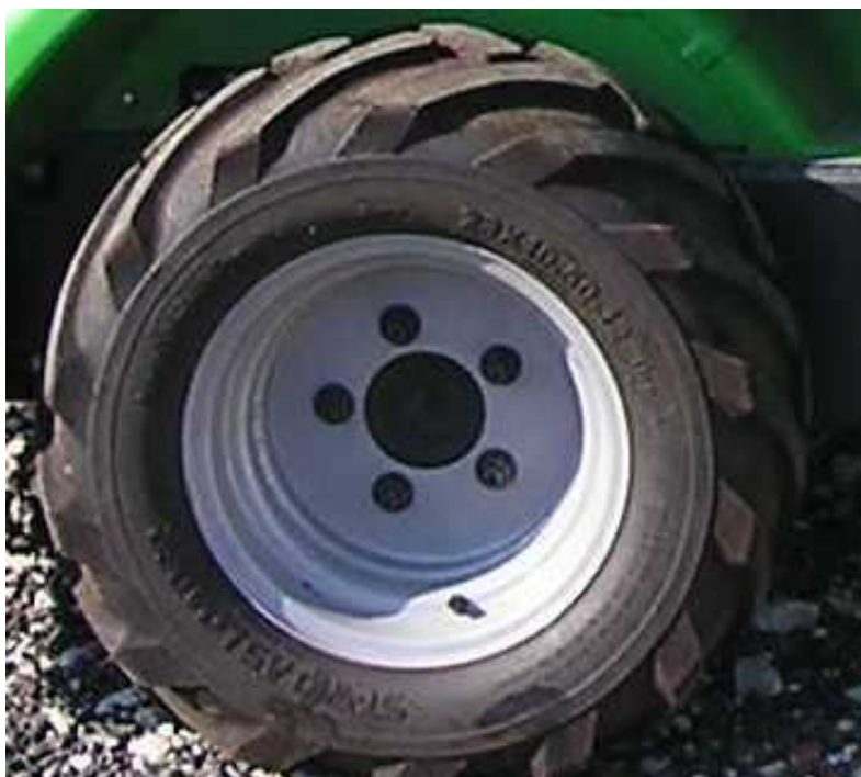
Zdjęcie Nr 14 Widok opony STAR CO.AS. Loader 23x10.50-12” – zużyte w ok. 7%
