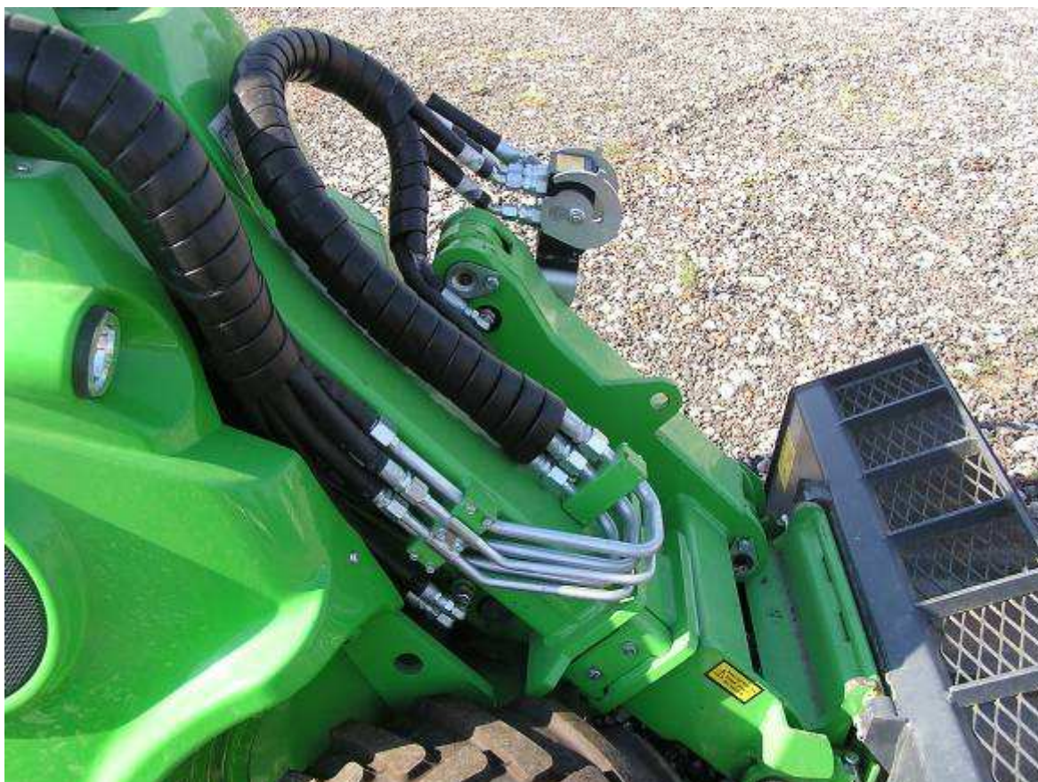
Zdjęcie Nr 7 Widok ładowarki AVANT 630 – przewody hydrauliczne ładowarki
